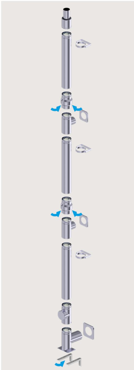
Die „MFB-Außenwand“ ermöglicht es, in Mehrfamilienhäusern mit mehreren konventionellen Heizgeräten schrittweise auf die Brennwerttechnik umzustellen. Die Herausforderung dabei: konventionelle Heizgeräte können nicht zusammen mit Brennwertgeräten an einem Abgasstrang im Überdruck betrieben werden.
