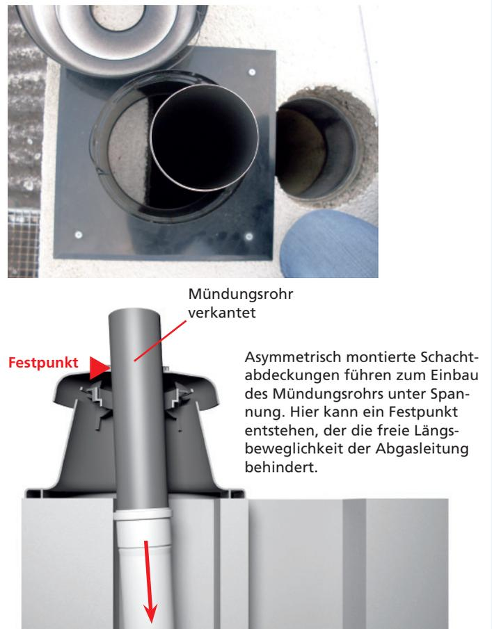
**Problemfall: Kombination einwandiger Abgasleitungen mit Abgas-Zuluft-Systemen im Dachbereich**
