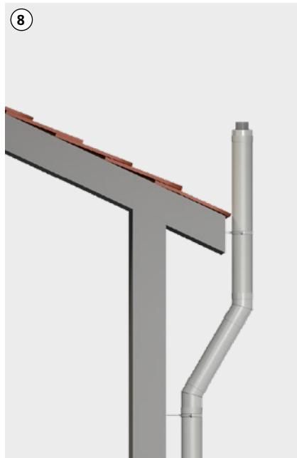
Bei bestimmten Situationen kann eine Schrägführung der konzentrischen Abgasleitung erforderlich sein. Hierzu werden 30° oder 45° Bögen verwendet.
