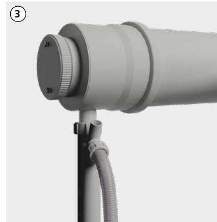
Am Ende des Kaskadensammlers den Abschlussdeckel mit Revision und Kondensatablauf positionieren. Siphon mit min. Sperrwasserhöhe von 150 mm installieren. Hinweise zur Kondensateinleitung beachten.
