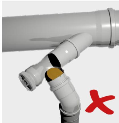
Waagerechte sowie diagonale Einbaulage unzulässig.
