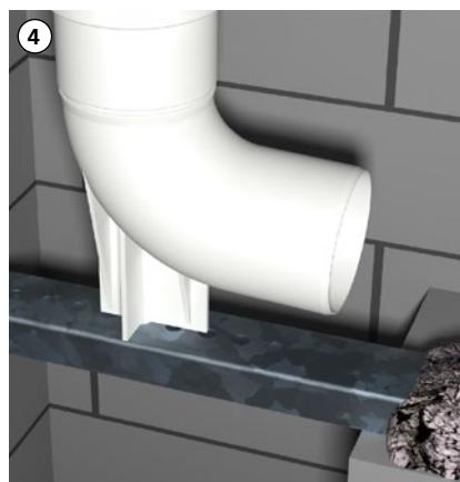
Die Montage der Auflageschiene und des Stützbogens erfolgt bei dem Flexsystem nahezu gleich.
