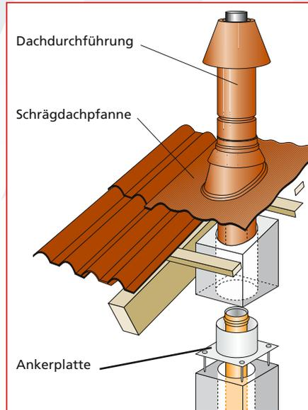
Die Dachdurchführung ist in zwei Längen und zwei Farben lieferbar. Die Schrägdachpfanne lässt sich im Neigungswinkel einstellen. So bietet **UNIFIX** die individuelle Lösung für fast jedes Dach.
