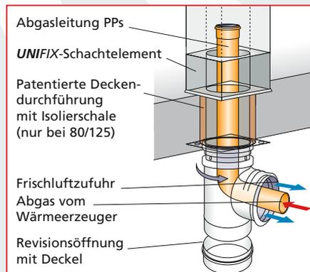
Das patentierte Deckenanschlusselement ermöglicht die Überprüfung von Ringspalt und Abgasleitung. Ganz einfach von unten. Zusätzliche Einrichtungen wie ein Dachausstieg sind nicht mehr erforderlich.
