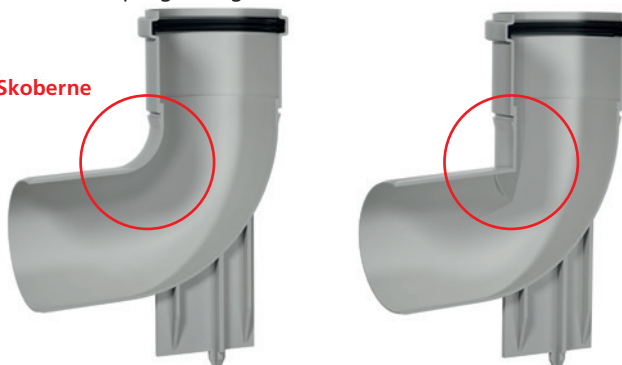
Bild 3: Beispiel Stützbogen. Der Biegeradius entscheidet mit darüber, ob die Abgasleitung – wie beim Skoberne Produkt (linkes Bild) – von unten überprüft und mit der Kehrhaspel gereinigt werden kann.
