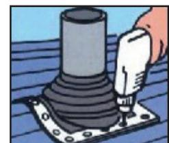
5. Dektite® mit JT 3 Edelstahl-Bohrschrauben oder Bulbtite-Nieten befestigen. Zusätzliche Sicherung durch Rohrschelle möglich.
